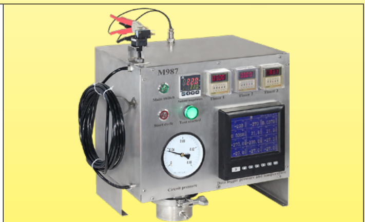
根据推动按钮的体积及其产生的压力反复不断地测量空气开关连接管的最大长度的测试设备 (Ultimheat 实验室)
